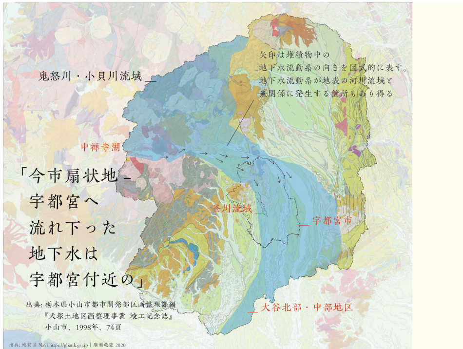
図 14 栃木県の表層地質と河川流域、およその地下水流動系の重なりを見る
